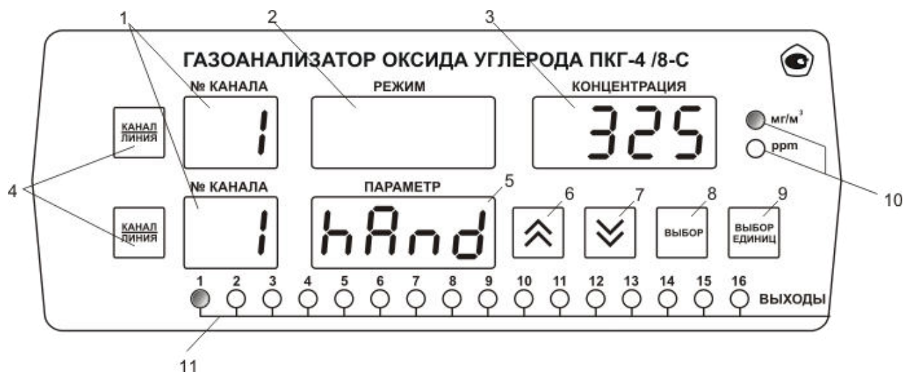
Рисунок 3.1 Вид лицевой панели газоанализатора оксида углерода ПКГ-4 /8-С-СО
